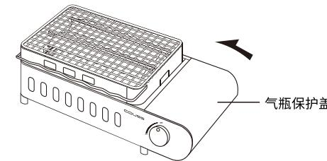
5.拉出接汁盘（储水盘）加入适量的水，水量不要超过最大水位标识线。
