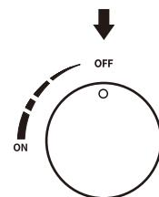
温馨提示：如点火开关旋钮未转至“OFF”位置，气瓶将无法安装，或出现漏气的危险。
