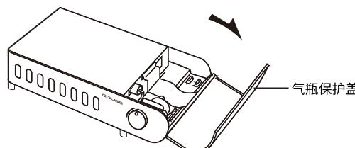
3.把气瓶切口凹部对准气瓶嵌入导轨凸部，并平稳滑动插入，直至完全与磁铁紧贴。
